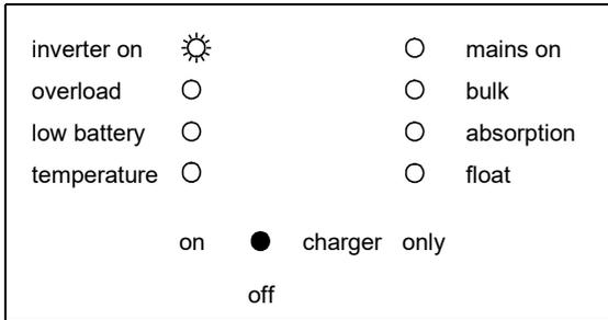
**Remarque** : Lorsque les voyants « overload » et « low battery » sont allumés simultanément c'est parce que le Multi(Plus), ou l'Inverter Compact, s'est éteint en raison d'une tension d'ondulation CC excessive.
