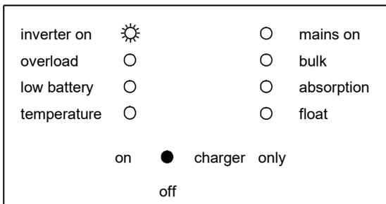
**Anmerkung:** Wenn die LEDs „Überlast“ und „Batterie Leer“ gleichzeitig brennen, hat sich das Gerät wegen zu hoher Brummspannung abgeschaltet.
