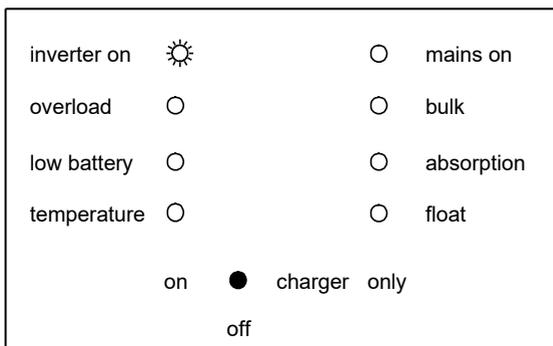
**Nota:** Cuando los LED "Overload" y "Low Battery" están encendidos simultáneamente, el Multi(Plus), o el Inverter Compact, se ha apagado debido a un exceso de ondulación de tensión CC.
