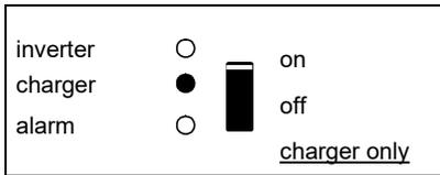
De netspanning is doorgeschakeld en de lader staat in bulk of absorption mode.
