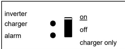
Die Wechselspannung ist durchgeschaltet und das Ladegerät ist abgeschaltet. Das Ladegerät erreicht nicht die Sollspannung (bulk protection Modus).
