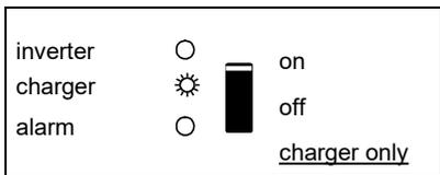
La tension réseau est transférée et le chargeur fonctionne en mode float.
