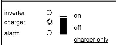
Die Wechselspannung ist durchgeschaltet und das Ladegerät arbeitet im Spannungs-Erhaltungsmodus
