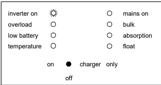
Opm.: Wanneer de LEDs "overload" en "low battery" tegelijk branden, is het apparaat uitgeschakeld ten gevolge van te hoge rimpel op de gelijkspanning.
