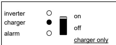
Die Wechselspannung ist durchgeschaltet und das Ladegerät arbeitet im Konstantstrom- oder Konstantspannungs-Modus.
