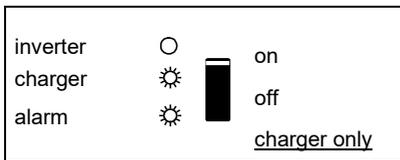
De netspanning is doorgeschakeld en er is een vooralarm: overbelasting of de lader is warm.
