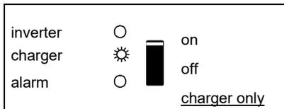
La tensión CA de entrada se conmuta y el cargador funciona en modo flotación.
