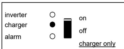
La tensión CA de entrada se activa y el cargador funciona en modo de carga inicial o de absorción.
