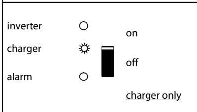
Die Wechselspannung ist durchgeschaltet und das Ladegerät arbeitet im Spannungserhaltungsmodus.
