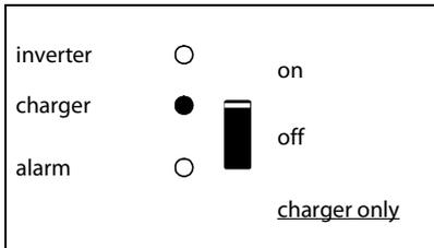
La tension d'entrée CA est commutée et le chargeur fonctionne en mode Bulk ou absorption.
