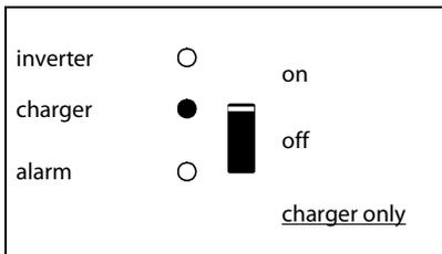
De netspanning is doorgeschakeld en de lader staat in bulk of absorption mode.
