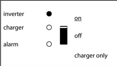
Batterij bedrijf. De omvormer staat aan en levert vermogen aan de belasting.
