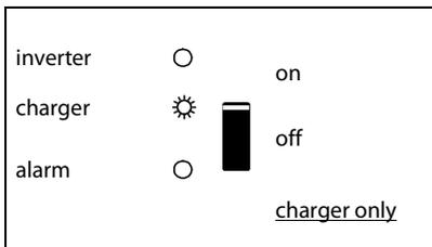
La tensión CA de entrada se conmuta y el cargador funciona en modo flotación.
