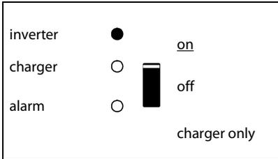
Der Wechselrichter ist eingeschaltet und liefert Leistung an die Verbraucher Batteriebetrieb.
