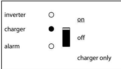
Die Wechselspannung ist durchgeschaltet und das Ladegerät arbeitet im Konstantstrom- oder Konstantspannungs-Modus.
