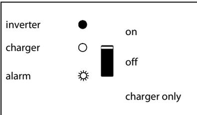
De omvormer is ingeschakeld en levert vermogen aan de belasting.
