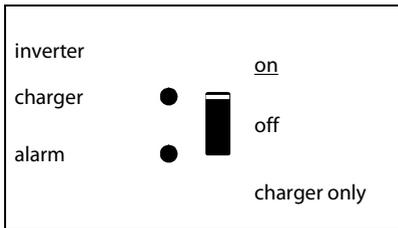
Die Wechselspannung ist durchgeschaltet und das Ladegerät ist abgeschaltet. Das Ladegerät erreicht nicht die Sollspannung (bulk protection Modus).
